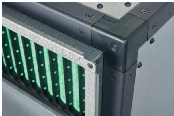
Utiliser un boulon de 8 mm avec écrou à chaque coin et un nombre suffisant de colliers à vis avec **une distance entre les colliers à vis qui ne dépasse pas 300 mm** pour maintenir la gaine, le registre, la batterie ou le piège à son serrés ensemble
