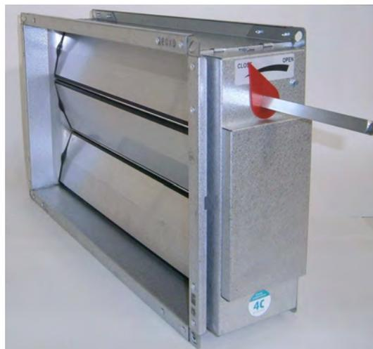
Les joints d'étanchéité en bout de lames et sur le cadre doivent être vérifiés une fois l'an. Ces joints ne doivent être ni lubrifiés, ni traités d'aucune manière.
