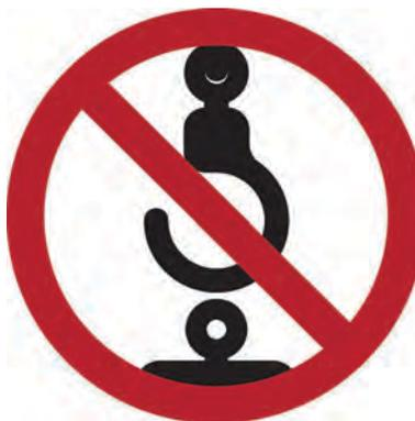
Les supports des centrales Geniox dans la taille 20 ne sont pas destinés pour le levage de la centrale. Ce support est destiné à maintenir ensemble en permanence les 2 sections avec des boulons de 8 mm.
