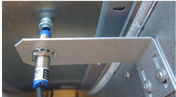
Vérifier la vis illustrée sur le rotor pour l'activation du signal à partir du capteur.
