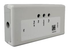
Allgemeines: Mit einem externen Wahlschalter kann eine von 3 voreingestellten Drehzahlen ausgewählt werden. Die Voreinstellung erfolgt mit je einem eingebauten Potentiometer.
