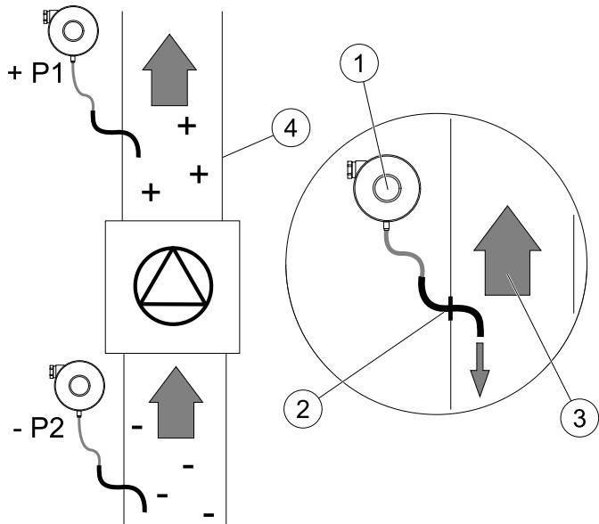
4. Schließen Sie ein 2-adriges Kabel vom Anschlusskasten (UI, 24V) an die Druckschalter (gemeinsam, normal offen) an.
