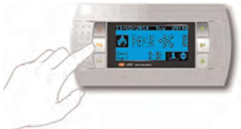
Dès que le mot de passe est entré dans l'écran de connexion et que la fonction a été sélectionnée, le niveau d'accès nécessaire pour modifier les valeurs sera affiché. Comme on peut le voir dans les écrans suivants, S clignote pour Service et M pour Manufacture :
