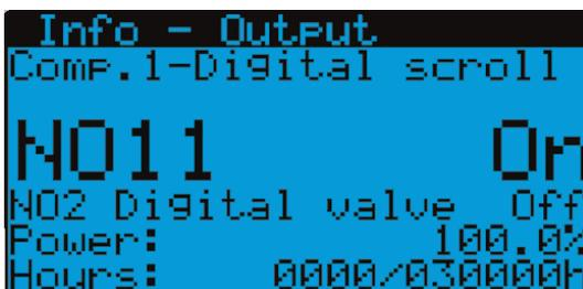
Affichage de l'état du compresseur numérique 1 et de la capacité de sortie réelle
