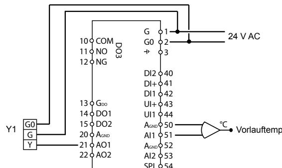
Abb. 4. Klemmenbelegung: OP10 mit 0...10 V Stellantrieb
