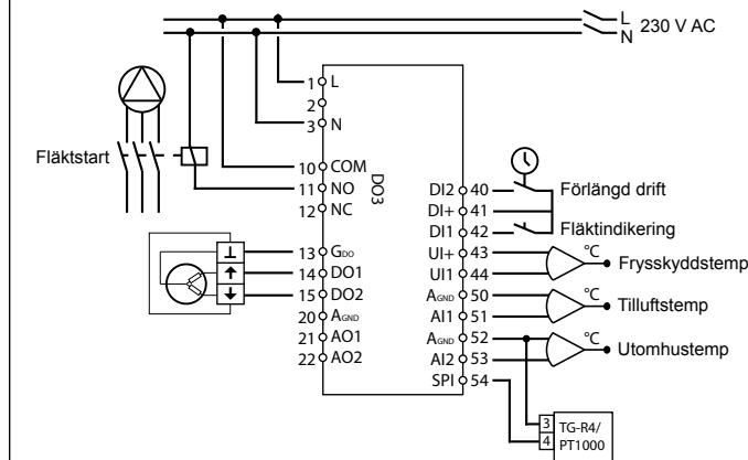
*Figur 2. Inkopplingsexempel: OP10-230 med vattenvärme, 3-lägesutgång. Tillflutsreglering med utetemperaturkompensering och extern börvärdesomställare.*
