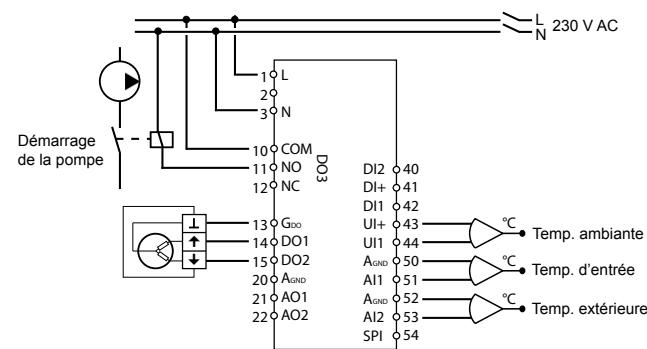
Figure 3. Exemple de raccordement : OP10-230 avec moteur 3 points et sonde de température d'ambiance (s'utilise également sans sonde ambiante). Les sorties numériques ont une tension de 24 VAC, GDO est commun et DO est connecté à G0. Pour OP10, DO1 et DO2, les sorties acceptent 12 VA. Pour OP10-230, DO1 et DO2, les sorties acceptent 3,8 VA moyennant l'utilisation du transformateur interne.
