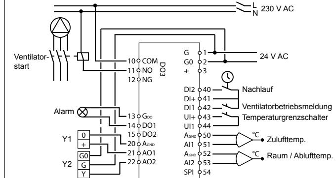
Abb. 1. Klemmenbelegung: OP10 mit Erhitzer (elektrisch) (z. B. über PULSER-X/D oder TTC25X) und Klappen. Kaskadenregelung.
