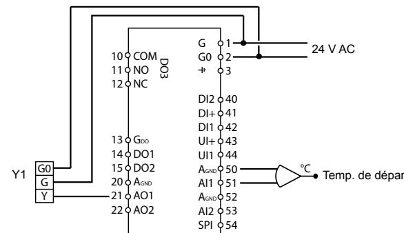
Figure 4. Exemple de raccordement : OP10 avec moteur 0...10 V
