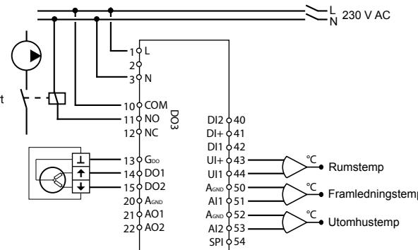
Figur 3. Inkopplingsexempel: OP10-230 med 3-lägesställdon och rumstemperaturgivare (kan även användas utan rumstemperaturgivare).
