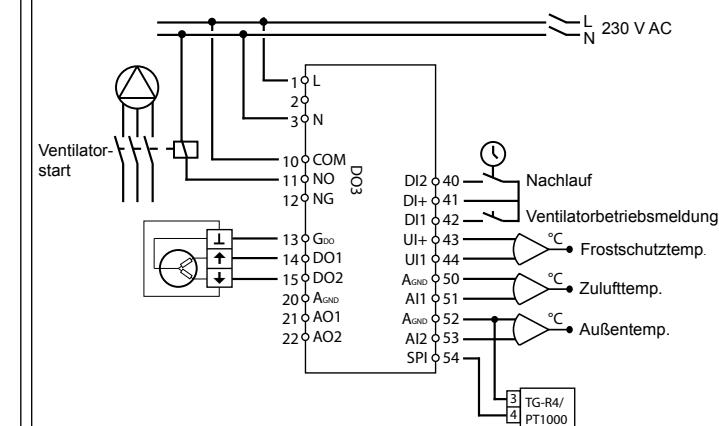
Abb. 2. Klemmenbelegung: OP10-230 mit Erhitzer (Wasser), 3-Punkt-Ausgang. Außentemperaturgeführte Zulufttemperaturregelung mit externem Sollwertgeber.
