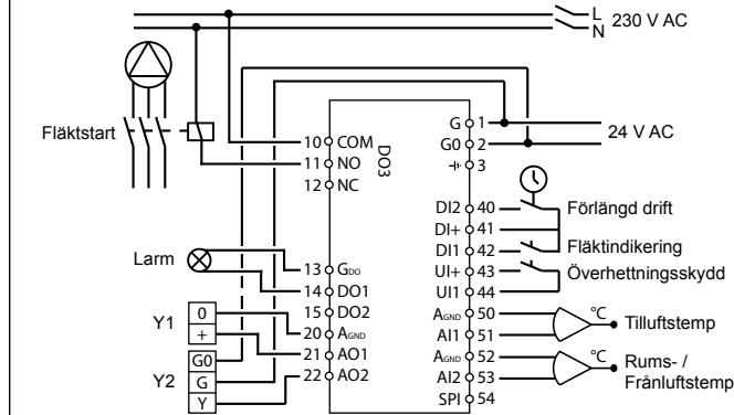
*Figur 1. Inkopplingsexempel: OP10 med elvärme (till exempel via PULSE-X/D eller TTC25X) och spjäll. Kaskadreglering.*
