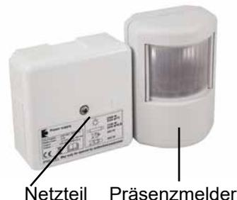
Das Netzteil kann im Allgemeinen den Klemmenkasten ersetzen, der sich am bestehenden Knotenpunkt zwischen Phase Ein/Aus und dem Leistungsschalter befindet; in diesem Fall muss kein separates Stromkabel installiert werden. Es übernimmt die Funktion des Netzteils, des Ausgangsrelais und eines einfachen Logikmoduls. Ein externer Schalter für das manuelle Ein- und Ausschalten kann angeschlossen werden. Das Netzteil ist ferner mit einem Anschluss für einen Erdungsschutz versehen.
