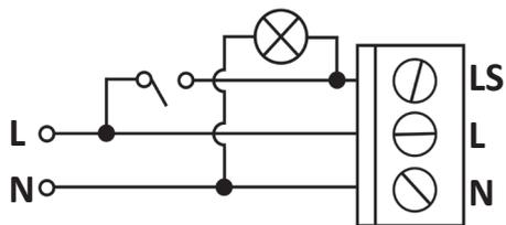
**17** • När kabelledningarna ansluts till kopplingsplintarna, ska inte skruvarna dras åt för mycket: max. moment är 0,15 Nm.
