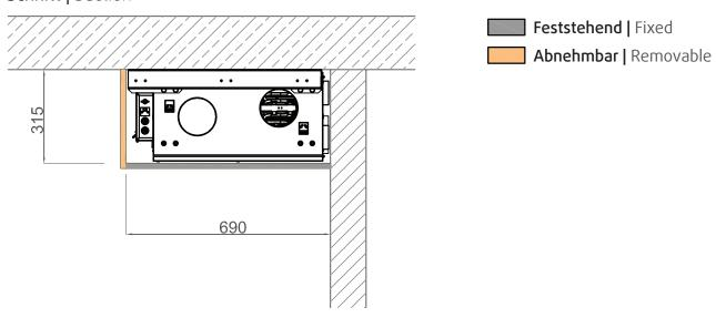
Schnitt - Gerät ausgezogen | Section - pulled out unit
