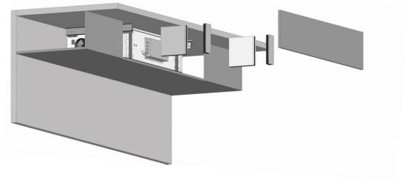
Gerät ausgezogen, Revisionsklappe offen | Pulled out unit, inspection door open
