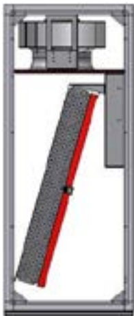
Position Luftfilter Einheit P mit Luftaus- lass nach oben
