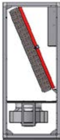
Position Luftfilter Einheit P mit Luftaus- lass nach unten
