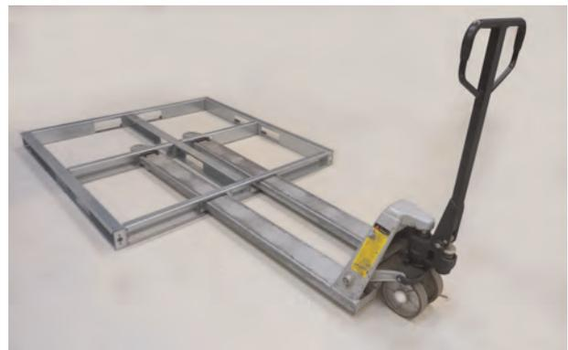
Ne pas actionner pas les roues du chariot élévateur sur le profilé horizontal ou un profilé central. L'activation des roues sur le profilé horizontal peut déformer le profilé.
