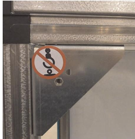
Les supports des centrales Geniox dans les tailles 10 à 18 ne sont pas destinés pour le levage de la centrale. Ce support est destiné à maintenir ensemble de manière permanente les deux sections avec des boulons de 8 mm.
