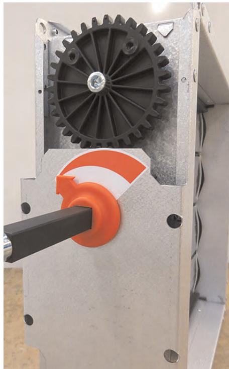
Les lamelles sont équipées de roulements synthétiques ne nécessitant aucune lubrification. L'étanchéité du registre, lorsque celui-ci est en position fermé, doit être vérifiée visuellement au moins une fois par an. Le moteur doit être ajusté si le registre ne se ferme pas complètement.
