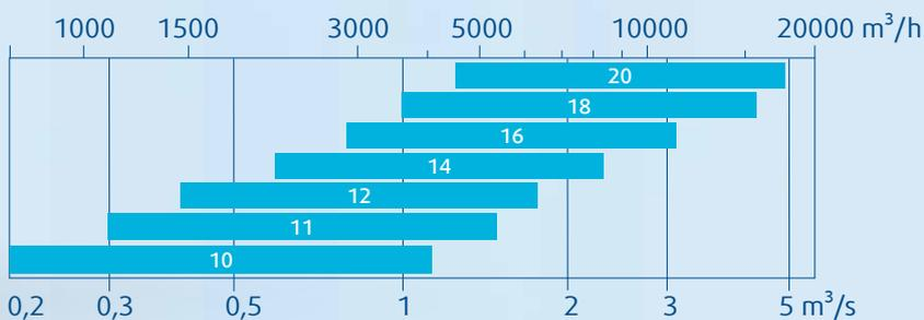
Luftmengen für Geniox Core gemäß Ecodesign. Die Luftmengen wurden mit Rotationswärmeübertrager und EC-Motoren ermittelt.
