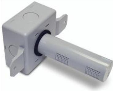
Die CO<sub>2</sub> Kanaleinbaufühler sind Transmitter für den Einbau in Abluftkanälen von Heizungs-, Lüftungs- und Klimatisierungssystemen. Die Technologie basiert auf der Absorption von Licht in einem goldbeschichteten, re-
