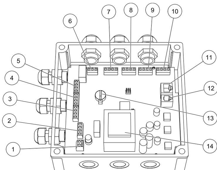
**Fig. 5 Connexions internes du tableau de commande**
