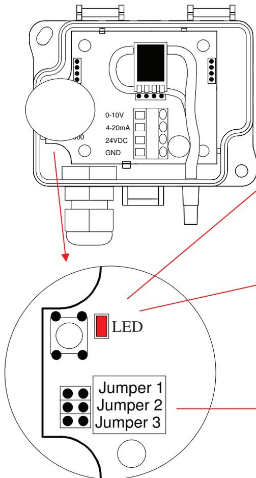
**ZEROING:** press the button over 4 seconds
