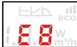
**Abb. 16:** Anzeige Fehlermeldung E8 (Motorfehler)
