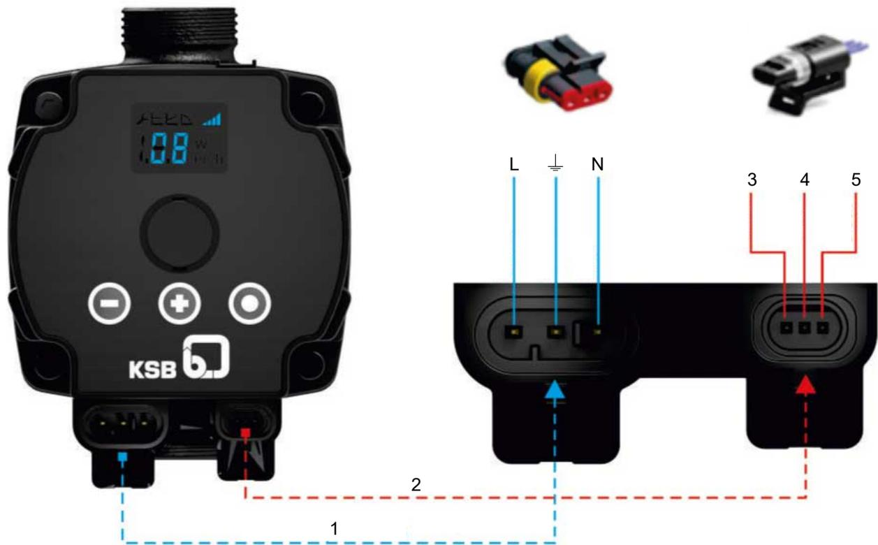
**Abb. 4:** Elektrische Anschlussleitung und Steuerleitung anschließen
