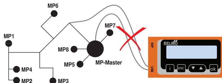
Lösung: Servicebuchse am Antrieb benutzen oder den MP-Anschluss des MP-Geräts temporär vom MP-Bus trennen und das ZTH EU an den MP-Anschluss anschliessen.
