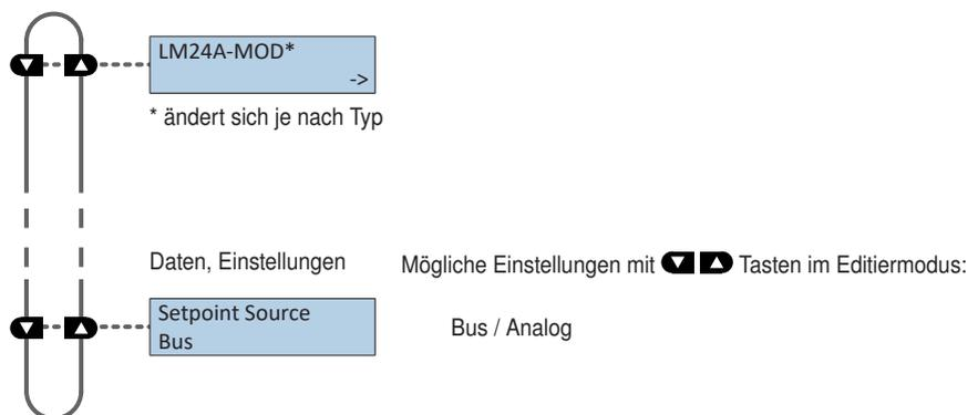
**Auswahl Bus:** Die Ansteuerung erfolgt ausschliesslich via ausgewähltem Busprotokoll (Modbus oder BACnet)
