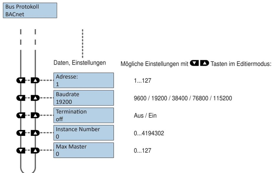
Funktionen für -MOD Antriebe (Modbus/ BACnet /MP-Bus)
