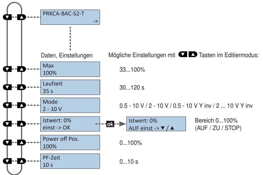
**Funktionen für Drehantriebe mit hohem Drehmoment**
