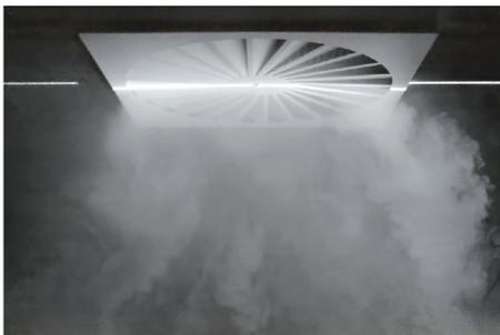
Aria calda d'immissione  $T > 22^{\circ}\text{C}$
