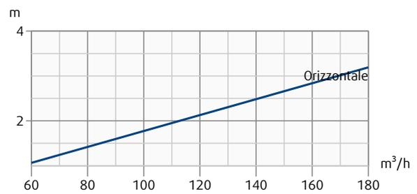
Perdite di carico e livello di potenza sonora irradiata in funzione della portata dell'aria, misurate con il plenum THOR-F. Lunghezza del lancio con velocità terminale 0,2 m/s in funzione della portata dell'aria.
