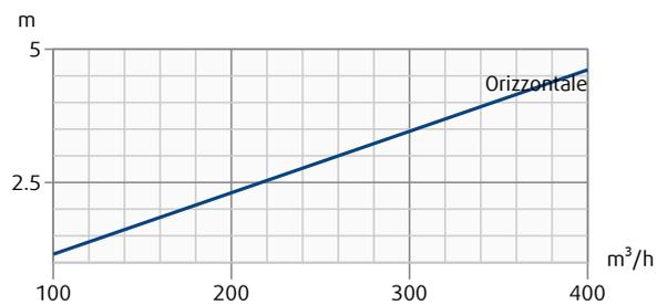
Perdite di carico e livello di potenza sonora irradiata in funzione della portata dell'aria, misurate con il plenum THOR.
