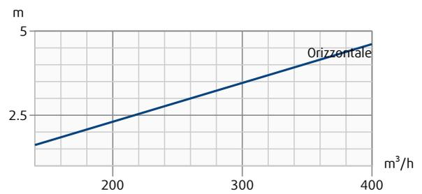
Perdite di carico e livello di potenza sonora irradiata in funzione della portata dell'aria, misurate con il plenum THOR-E. Lunghezza del lancio con velocità terminale 0,2 m/s in funzione della portata dell'aria.
