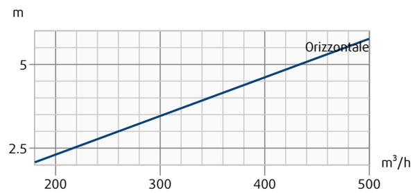
Perdite di carico e livello di potenza sonora irradiata in funzione della portata dell'aria, misurate con il plenum THOR-F. Lunghezza del lancio con velocità terminale 0,2 m/s in funzione della portata dell'aria.
