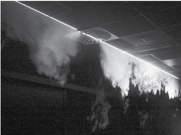
Fig. 1: Isothermal air flow visualisation
