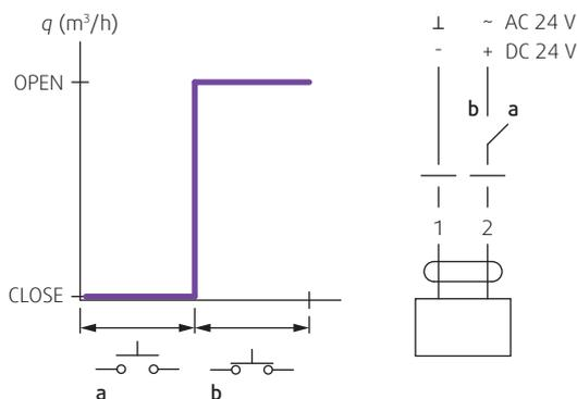
Spannungsversorgung: AC 24 V/50 - 60 Hz or DC 24 V
