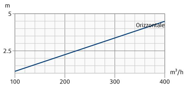
Perdite di carico e livello di potenza sonora irradiata in funzione della portata dell'aria misurati con il plenum THOR-F.
