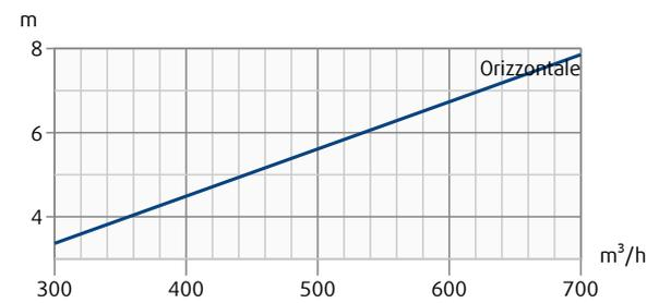
Perdite di carico e livello di potenza sonora irradiata in funzione della portata dell'aria misurati con il plenum CBO.
