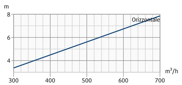
Perdite di carico e livello di potenza sonora irradiata in funzione della portata dell'aria misurati con il plenum THOR-E. Lunghezza del lancio con velocità terminale 0,2 m/s in funzione della portata dell'aria.
