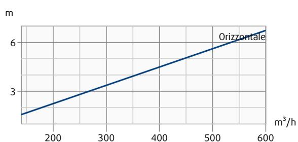
Perdite di carico e livello di potenza sonora irradiata in funzione della portata dell'aria misurati con il plenum THOR.
