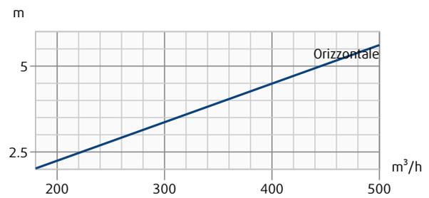
Perdite di carico e livello di potenza sonora irradiata in funzione della portata dell'aria misurati con il plenum THOR. Lunghezza del lancio con velocità terminale 0,2 m/s in funzione della portata dell'aria.
