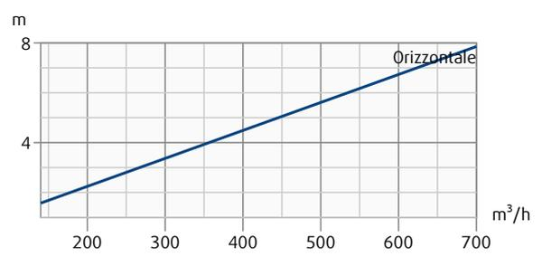
Perdite di carico e livello di potenza sonora irradiata in funzione della portata dell'aria misurati con il plenum CBO.
