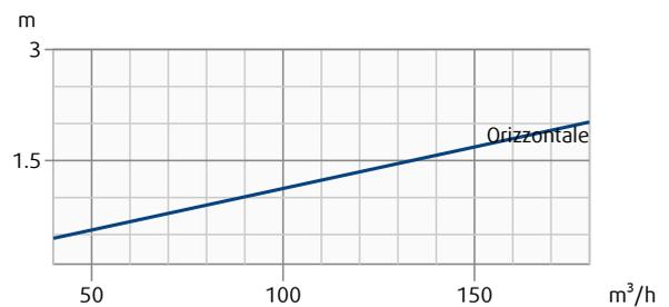
Perdite di carico e livello di potenza sonora irradiata in funzione della portata dell'aria misurati con il plenum THOR-E.
