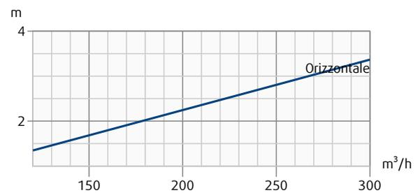
Perdite di carico e livello di potenza sonora irradiata in funzione della portata dell'aria misurati con il plenum CBO. Lunghezza del lancio con velocità terminale 0,2 m/s in funzione della portata dell'aria.
