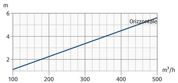
Perdite di carico e livello di potenza sonora irradiata in funzione della portata dell'aria misurati con il plenum THOR-E.
