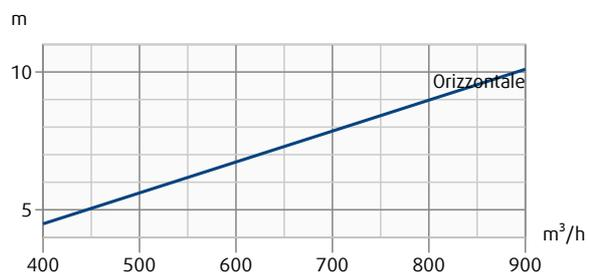
Perdite di carico e livello di potenza sonora irradiata in funzione della portata dell'aria misurati con il plenum THOR-F. Lunghezza del lancio con velocità terminale 0,2 m/s in funzione della portata dell'aria.
