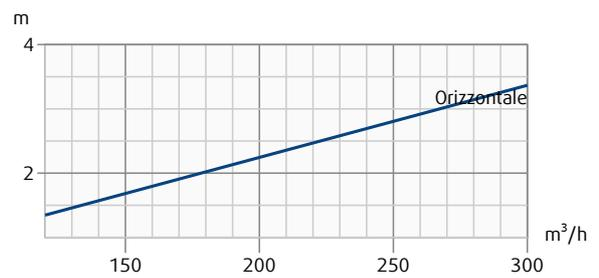
Perdite di carico e livello di potenza sonora irradiata in funzione della portata dell'aria.
