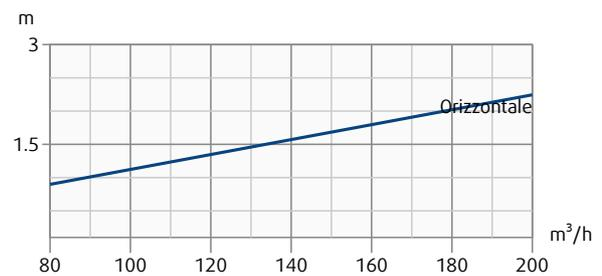
Perdite di carico e livello di potenza sonora irradiata in funzione della portata dell'aria misurati con il plenum THOR.
