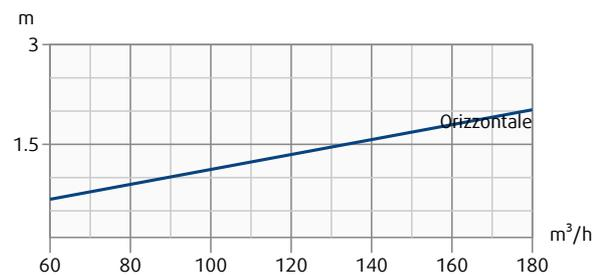
Perdite di carico e livello di potenza sonora irradiata in funzione della portata dell'aria misurati con il plenum THOR-F. Lunghezza del lancio con velocità terminale 0,2 m/s in funzione della portata dell'aria.
