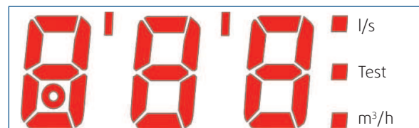
3 Ziffern mit 7-Segment-Anzeige
