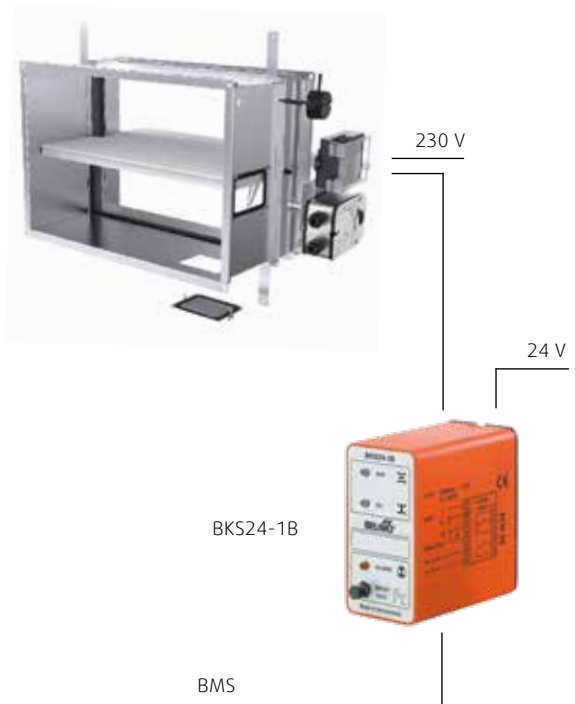
Obr. 31b: Schéma zapojení FD a BKS24-1B
