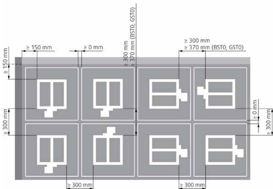
Obr. 38i: Minimální odstupové vzdálenosti mezi klapkami FDS-xxx-KS, instalace pomocí KIT ④
