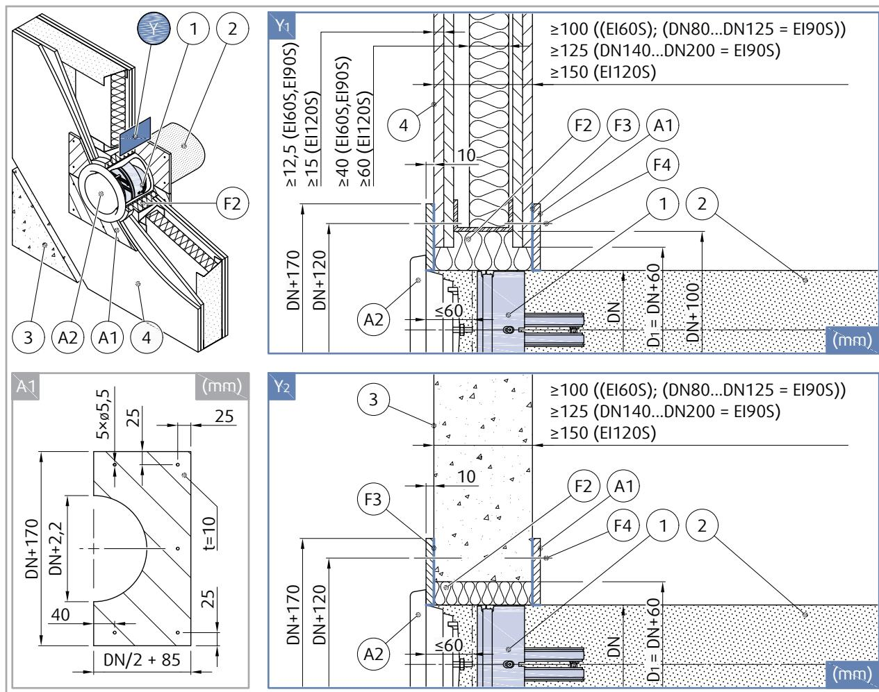
**Otvor a příprava stěny/stropu**
