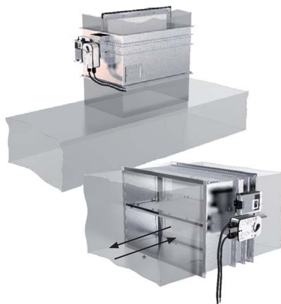
Obr. 2: Instalace hranaté kouřové klapky DKIS-1 na/do potrubí procházejícím vertikální podpůrnou konstrukcí ( v_{ed} - viz požární odolnost tab. 1)
