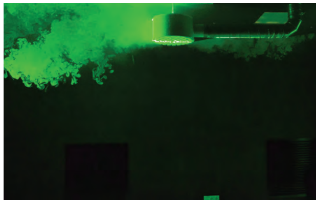
Obr. 1: Vizualizácia vzduchového prúdu (vľavo: vertikálny obraz prúdenia; vpravo: horizontálny obraz prúdenia)
