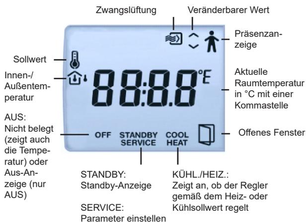
Mit Hilfe der Bedientasten können über das Display verschiedene Werte im Parametermenü eingestellt werden. Die Parameterwerte werden mit den ERHÖHEN- und SENKEN-Tasten geändert und danach durch Drücken der Präsenztaste bestätigt.
