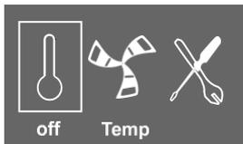
Wenn der elektrische Nacherhitzer aktiviert wird, dann wird er im manuellen Sommermodus ausgeschaltet. Der manuelle Sommermodus geht automatisch nach zwei Minuten auf Stufe 1 (Sollwert 12 °C), wenn die Zulufttemperatur kleiner oder gleich +5 °C ist.
